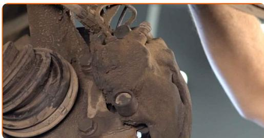
**20** Conecte o soquete elétrico do sensor de ABS. Conecte o sensor do indicador de desgaste das pastilhas de travão.
