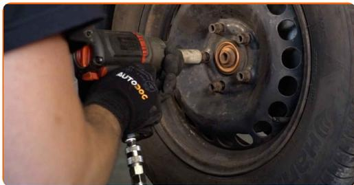
**26** Baixar o carro e trabalhar em ordem transversal, apertar os parafusos das rodas. Use uma chave de torque. Aperte-o para o torque de 120 Nm.
