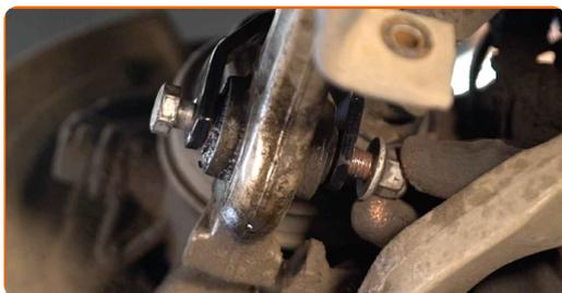
**54** Aparafuse o elemento de fixação inferior do amortecedor. Use uma chave combinada nº 18. Use uma chave soquete nº 18.
