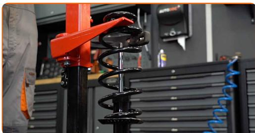
**41** Instale a manga para poeiras e a bomba de bloqueio no novo amortecedor.
