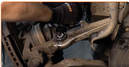
**53** Instale o parafuso de fixação.
