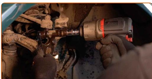
**14** Remova o parafuso de fixação. Use um saca-pino. Use um martelo.
