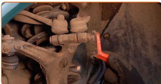
**13** Desaperte os parafusos do braço de suspensão superior (2 peças). Use uma chave combinada nº 16. Use uma chave soquete nº 16.
