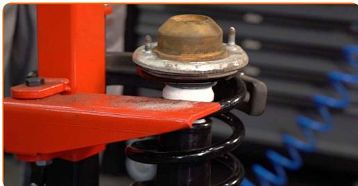
**45** Retire a coluna de suspensão montada.
