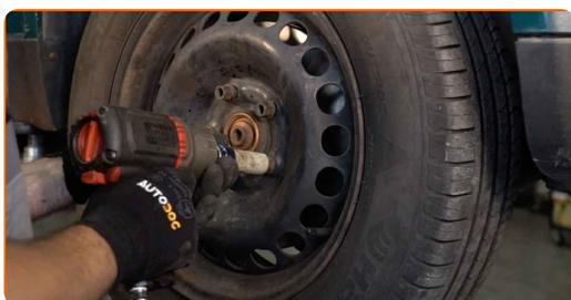
**73** Baixar o carro e trabalhar em ordem transversal, apertar os parafusos das rodas. Use uma chave de torque. Aperte-o para o torque de 120 Nm.
