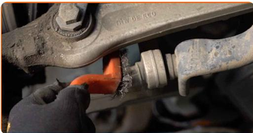
**17** Desaparafuse o fixador que conecta a bieleta da barra estabilizadora à barra estabilizadora. Use uma chave combinada nº 16 (2 peças).
