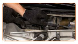
6 Remova o elemento de filtro a partir da caixa do filtro.
