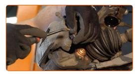
Desconecte o sensor do indicador de desgaste das pastilhas de travão. Use uma chave de fenda plana.
