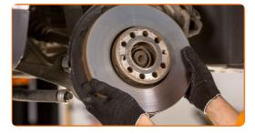
Limpe o cubo. Use uma escova metálica. Trate a superfície de contacto. Use massa de cobre.
