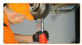
Aperte os fixadores inferiores que conectam a coluna de suspensão à manga de eixo. Use uma chave combinada nº 18. Use uma chave soquete nº 18. Use uma chave de torque. Aperte-o para o torque de 90 Nm.
