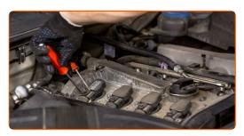
Retire as bobinas de ignição dos poços das velas de ignição.
