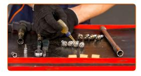
Instale as velas de ignição novas nos seus locais de montagem. Use o soquete da vela de ignição #16.
