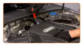
Aperte os fixadores da tampa do motor. Use uma chave de fenda plana.
