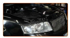
Use uma cobertura de proteção para prevenir a danificação da pintura e das peças plásticas do automóvel.
