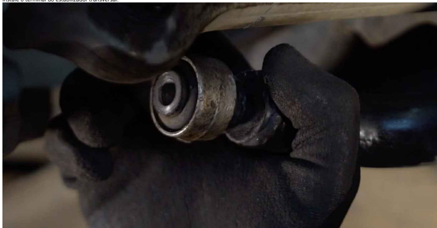
67 Aperte o fixador da bieleta da barra estabilizadora.
