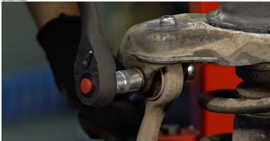
34 Desaparafuse os fixadores que ligam os braços de suspensão ao suporte do amortecedor. Use uma chave combinada nº 16. Use uma chave soquete nº 16. Use uma chave de catraca.
