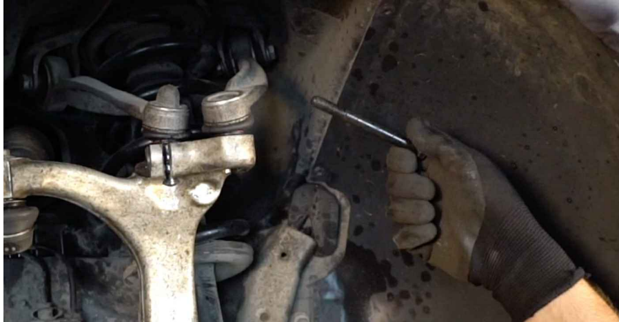
15 Apoie o braço. Use um macaco hidráulico de caixa de transmissão.
