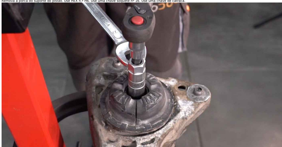
38 Remova a montagem do suporte superior.
