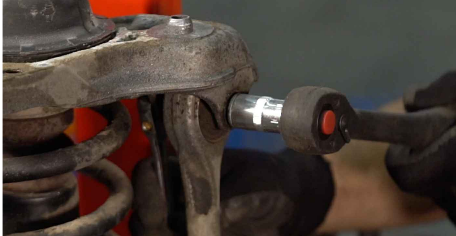
32 Remove o parafuso de fixação.
