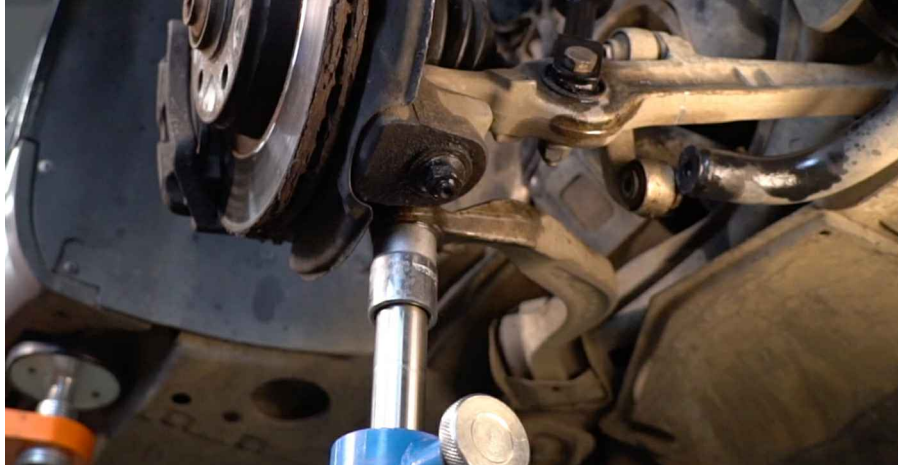
62 Trate todas as juntas do braço. Use um lubrificante multiusos. Use uma chave de fenda plana.
