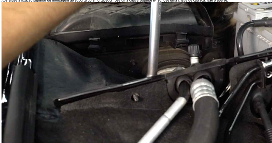
AUTODOC recomenda: • Audi A4 B6 Avant - Para evitar lesões, segure o suporte da suspensão enquanto aparafusa os parafusos de fixação.
