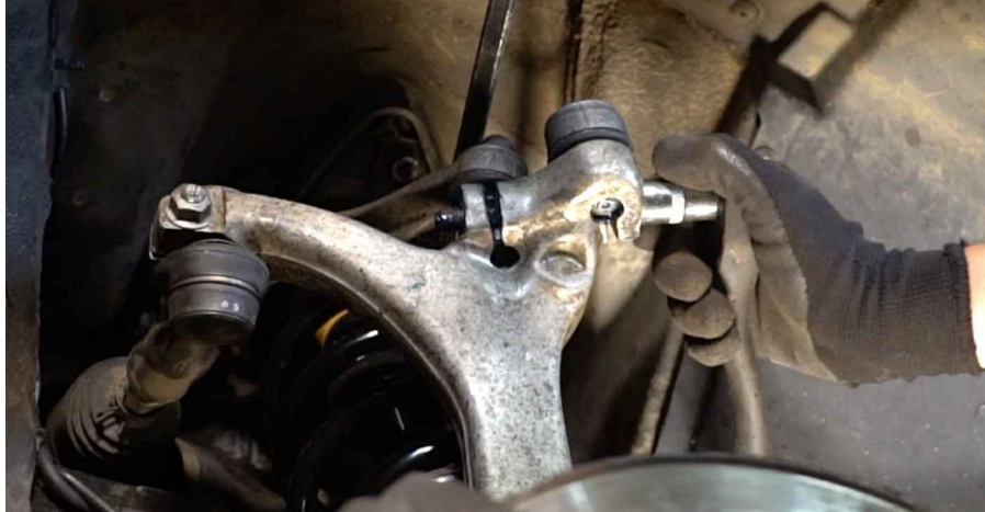
66 Instale o terminal do estabilizador transversal.
