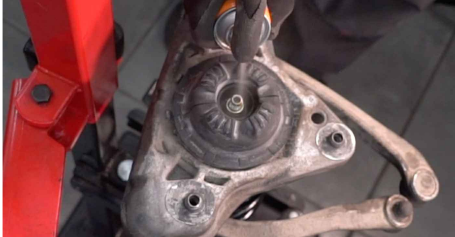
54 Retire a coluna de suspensão montada.
