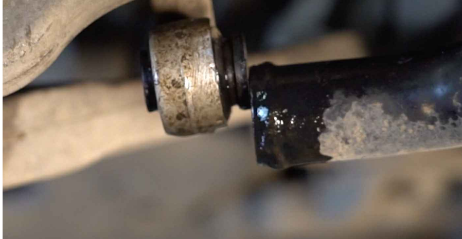
19 Limpe os elementos de fixação da coluna do amortecedor. Use uma escova metálica. Use spray WD-40.
