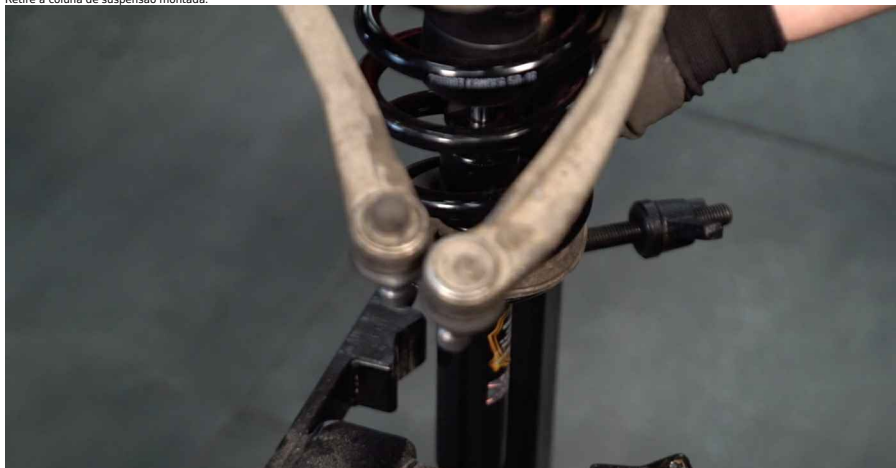
55 Instale o amortecedor no arco da roda.
