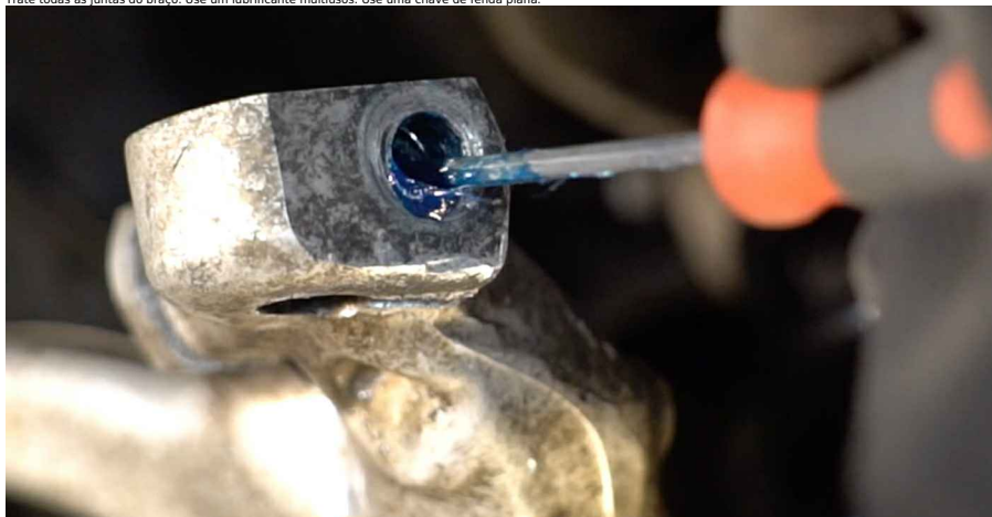
63 Junte o braço de suspensão superior à manga do eixo (2 peças).
