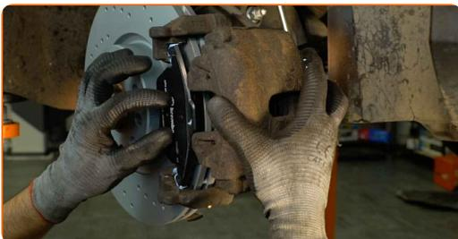
**28** Instale a pinça do travão e fixe-o. Use HEX n.º H7. Use uma chave de torque. Aperte-o para o torque de 30 Nm.
