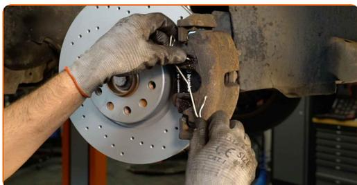
**31** Trate a superfície onde o disco de travão entra em contacto com o aro da roda. Use massa de cobre.
