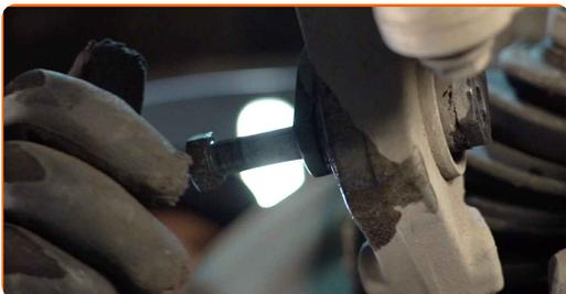
**9** Desenrosque as fixações superiores do braço. Use uma chave combinada nº 16. Use uma chave soquete nº 16. Use uma chave de catraca.
