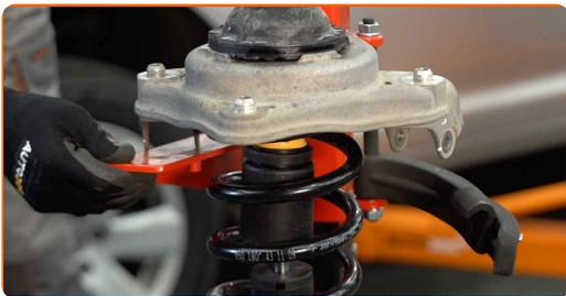
**35** Retire a coluna de suspensão montada.
