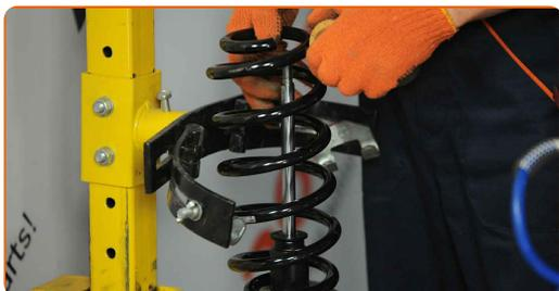
**30** Instale a coifa e o batente de encosto no amortecedor.
