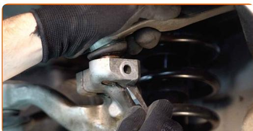
**48** Instale o parafuso de fixação. Use um martelo. Use um saca-pino.
