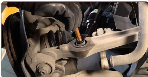
**47** Junte o braço de suspensão superior à manga do eixo. Use um martelo de borracha. Use um cinzel plano para metal. Use um martelo.
