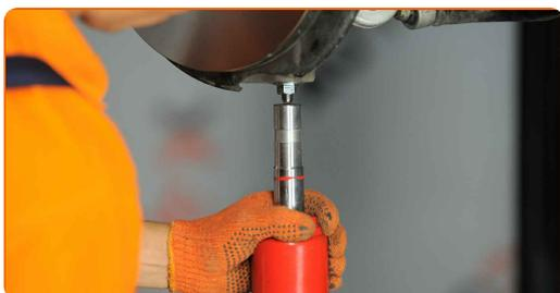
**51** Aperte a fixação inferior do amortecedor. Use uma chave combinada nº 18. Use uma chave soquete nº 18. Use uma chave de torque. Aperte-o para o torque de 90 Nm.
