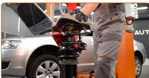
**33** Aperte a porca do suporte do amortecedor da haste do pistão. Use uma chave soquete nº 19. Use uma chave de catraca. Use uma chave de torque. Aperte-o para o torque de 50 Nm.
