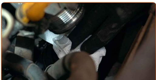
**11** Desaparafuse os fixadores que conectam a válvula do acelerador ao coletor de admissão. Use Torx T27. Use uma chave de catraca.
