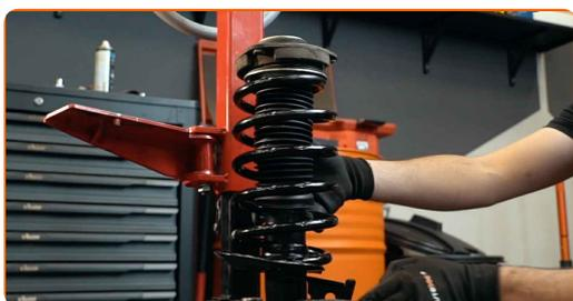
**47** Limpe os assentos de montagem da coluna do amortecedor. Use uma escova metálica. Use spray WD-40.
