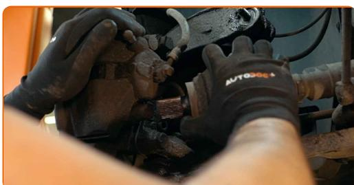
**26** Remova o parafuso de fixação.
