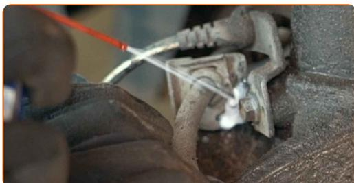
**17** Desaperte o suporte de fixação da mangueira do travão do amortecedor. Use uma chave combinada nº 10.
