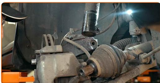
**29** Desaperte os fixadores superiores da coluna de suspensão.
