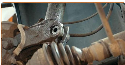
**28** Desligar a manga de eixo do suporte do amortecedor.
