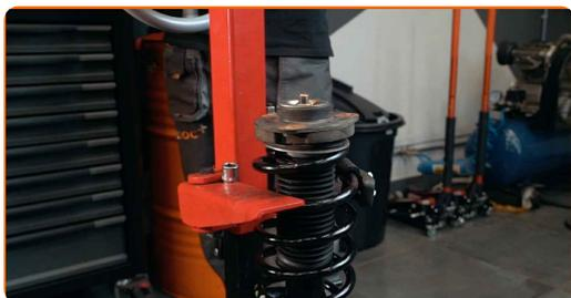
**46** Retire a coluna de suspensão montada.
