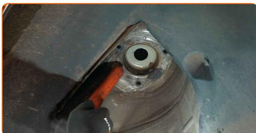
**48** Instale o amortecedor no arco da roda.
