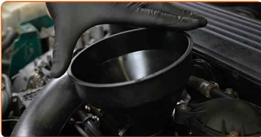
22 Despeje o óleo no motor através do gargalo de enchimento de óleo. Quantidade necessária de óleo: 4.25 l.
