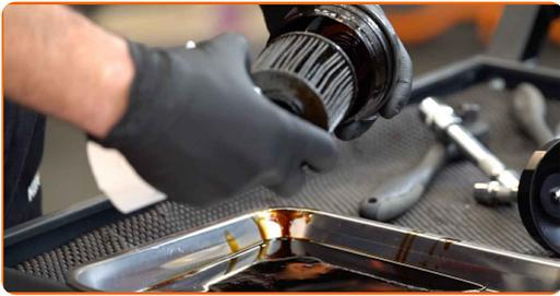
13 Retire anéis em O antigos da tampa do filtro de óleo. Use uma chave de fenda plana.
