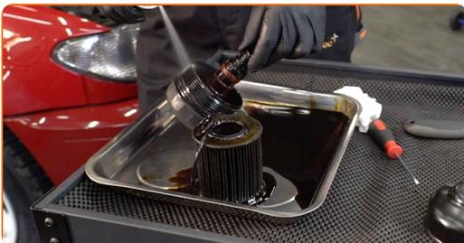
15 Instale anéis em O novos e um filtro de óleo novo nos seus locais de montagem na tampa do filtro.
