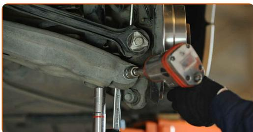
**11** Remova o parafuso de fixação. Use uma chave de fenda plana.
