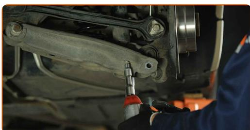
**20** Trate os fixadores do amortecedor. Use massa de cobre.
