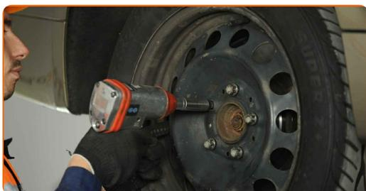
**29** Baixar o carro e trabalhar em ordem transversal, apertar os parafusos das rodas. Use o soquete de impacto para roda #17. Use uma chave de torque. Aperte-o para o torque de 120 Nm.
