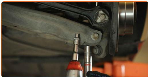
**9** Limpe os fixadores do braço de controlo. Use uma escova metálica. Use spray WD-40.
