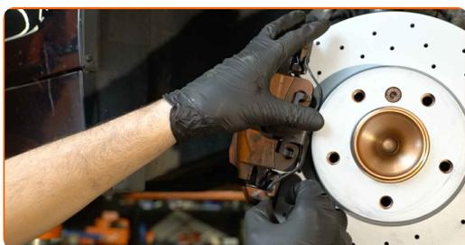
**35** Trate a superfície onde o disco de travão entra em contacto com o aro da roda. Use massa de cobre.
