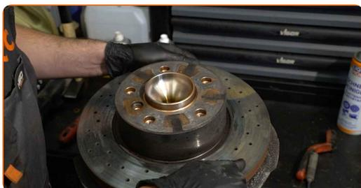
**43** Aperte a fixação do disco de travão. Use HEX n.º H6. Use uma chave de torque. Aperte-o para o torque de 9 Nm.
