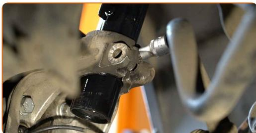
**47** Instale o parafuso de fixação.
