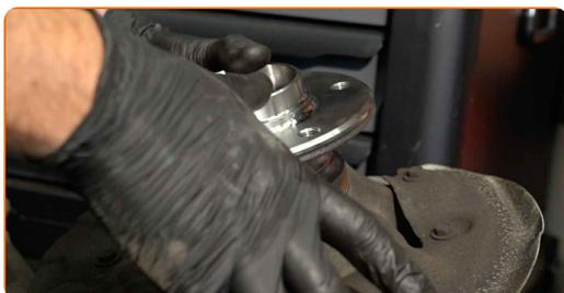
**40** Aperte o cubo. Use uma chave soquete nº 18. Use uma chave de torque. Aperte-o para o torque de 110 Nm.
