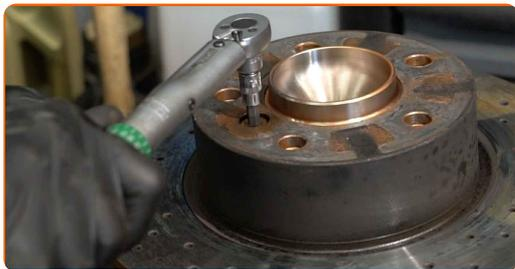
**44** Solte o torno e remova o mancal do eixo montado com o cubo de roda.
