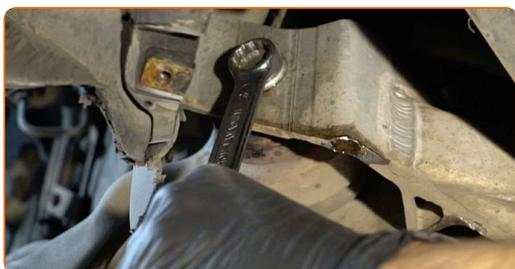
**23** Retire os parafusos de fixação.
