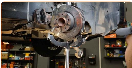
**27** Solte o fixador inferior que conecta a coluna de suspensão às mangas de eixo. Use uma chave especial para remover o amortecedor. Use uma chave de catraca.
