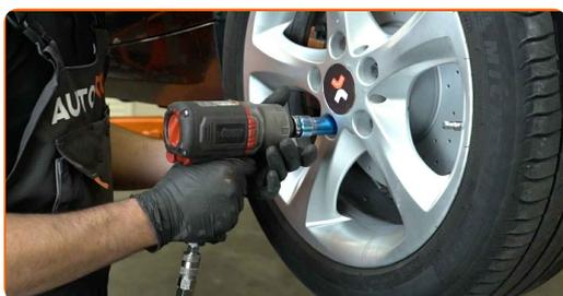
**18** Baixar o carro e trabalhar em ordem transversal, apertar os parafusos das rodas. Use o soquete de impacto para roda #17. Use uma chave de torque. Aperte-o para o torque de 120 Nm.
