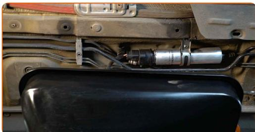
**3** Remova o anel de pressão do clipe de retenção do regulador de pressão de combustível. Use uma chave de fenda plana.
