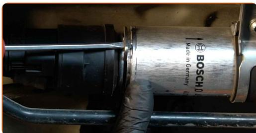
**4** Solte o grampo de fixação do tubo do filtro de combustível. Use uma chave de fenda plana.
