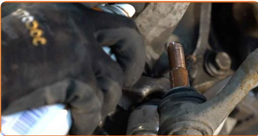
18 Instale o fixador traseiro do braço de suspensão.
