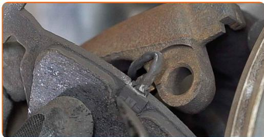
**19** Instale a pinça do travão e fixe-o. Use HEX n.º H7. Use uma chave de torque. Aperte-o para o torque de 30 Nm.
