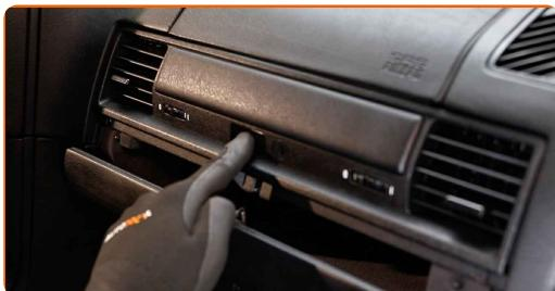
**3** Desaperte os parafusos de fixação do porta-luvas. Use a chave Phillips. Use uma chave de fenda plana.
