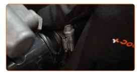
Solte a braçadeira de fixação da mangueira do líquido de refrigeração. Use uma chave soquete nº 7. Use uma chave de catraca.
