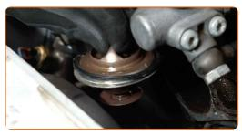
Limpe o assento de montagem da carcaça do termóstato. Use uma chave de fenda plana. Utilize um raspador de junta. Use o spray de limpeza universal.
