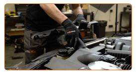
Desenrosque a tampa do depósito do líquido de refrigeração.
