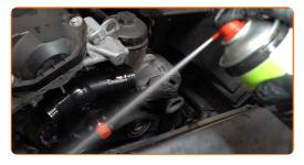
Conecte as mangueiras do líquido de refrigeração à carcaça do termóstato.
