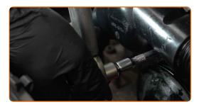
Fixe o suporte do tubo do líquido de refrigeração. Use uma chave soquete nº 13. Use uma chave de torque. Aperte-o para o torque de 11 Nm.
