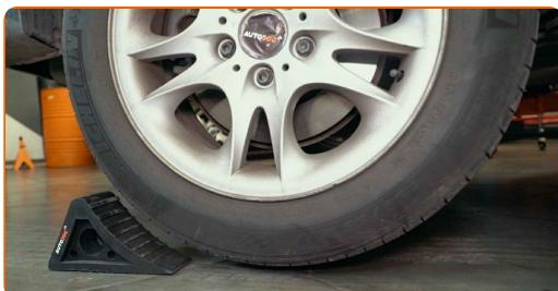
**4** Desaperte os parafusos da roda.
