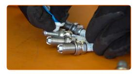
Instale as velas de ignição novas nos seus locais de montagem.
