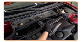
Desapertar os parafusos de fixação da caixa do filtro. Use Torx T20. Use uma chave de catraca.
