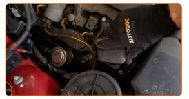
Desconecte os conectores das bobinas de ignição.
