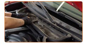
Insira o cartucho do filtro na caixa do filtro. Certifique-se de que a borda do filtro encaixa-se perfeitamente na caixa.
