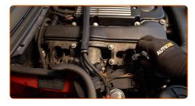
Aparafuse as novas velas de ignição e aperte-as. Use o soquete da vela de ignição #16. Use uma chave de torque. Aperte-o para o torque de 27 Nm.
