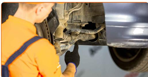
**7** Solte a porca de bloqueio que prende o terminal de direção à barra de direção. Use uma chave combinada nº 24.
