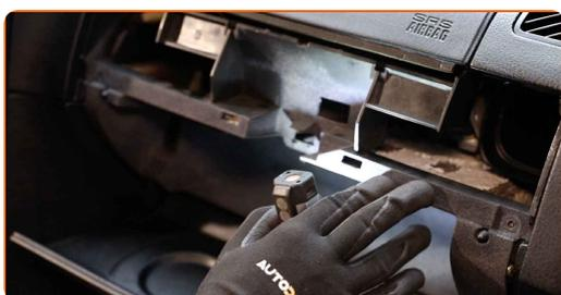
**21** Aparafuse os parafusos de fixação do porta-luvas. Use a chave Phillips.
