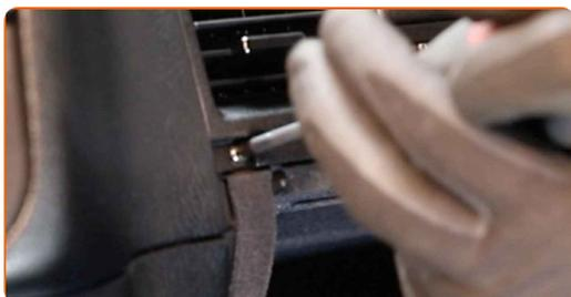
**4** Remova a grelha de ventilação.
