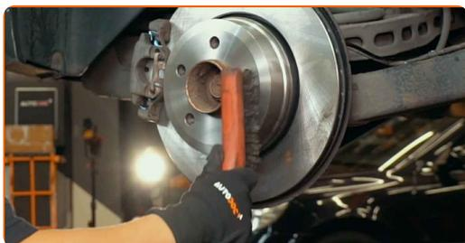
**26** Trate a superfície onde o disco de travão entra em contacto com o aro da roda. Use massa de cobre.
