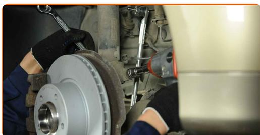
**19** Remova o parafuso de fixação.
