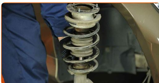
**28** Coloque o suporte do amortecedor sobre a ferramenta de compressão da mola.
