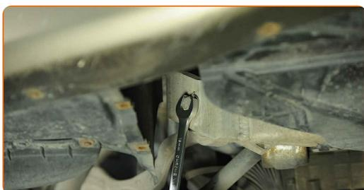
**51** Instale o terminal do estabilizador transversal.
