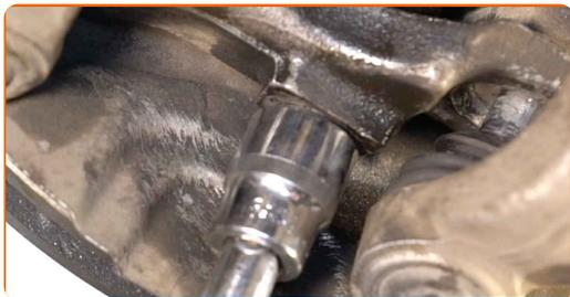
**57** Aperte o fixador frontal, conectando o braço de controlo à subestrutura. Use uma chave combinada nº 18. Use uma chave de torque. Aperte-o para o torque de 68 Nm.+90°
