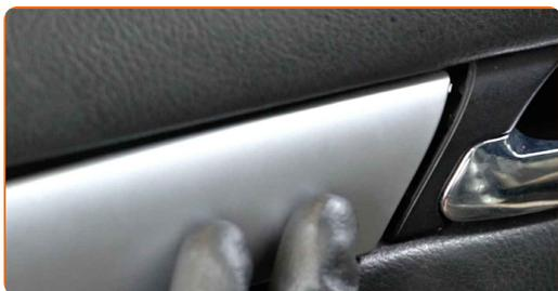
**44** Aparafuse o fixador do puxador da porta. Use Torx T25.
