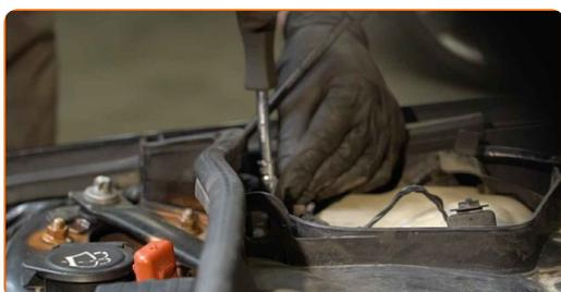
**9** Separe a conduta de cabos da parte superior do encaixe do microfiltro. Use uma chave de fenda plana.
