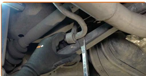
9 Limpe os elementos de fixação de conexão do estabilizador. Use uma escova metálica. Use spray WD-40.
