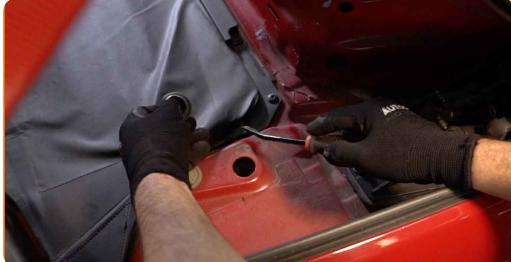
**3** Limpe os fixadores do suporte superior do amortecedor. Use spray WD-40.
