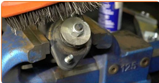
**19** Retire a fixação da haste do pistão do amortecedor. Utilize a chave para amortecedor DDNº6. Use uma chave soquete nº 16. Use uma chave de catraca.
