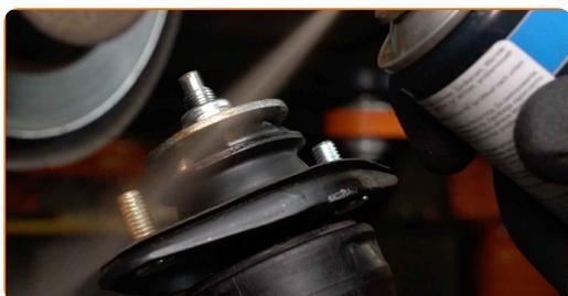
**25** Coloque o amortecedor no arco da roda e fixe-o.
