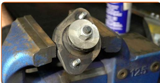
**18** Limpe o elemento de fixação de componentes do amortecedor. Use uma escova metálica. Use spray WD-40.
