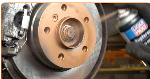
**34** Limpe a superfície do disco de travão. Utilize um produto de limpeza para travões.
