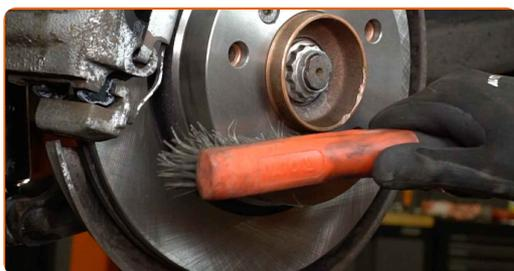
**33** Trate a superfície onde o disco de travão entra em contacto com o aro da roda. Use massa de cobre.
