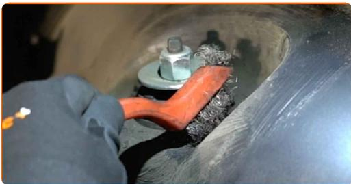
**5** Solte o fixador superior do amortecedor. Use uma chave soquete nº 13. Use uma chave de catraca.
