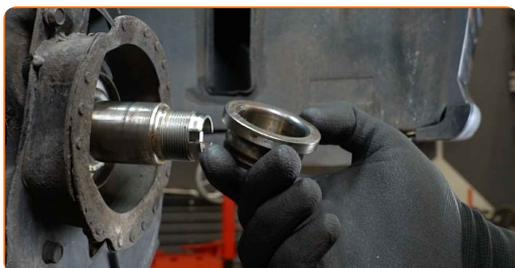
**19** Limpe o local de montagem do rolamento de cubo. Use uma escova metálica. Use o spray de limpeza universal.
