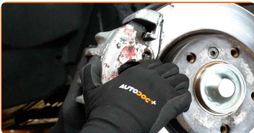
**29** Aperte a braçadeira da pinça do travão. Use uma chave soquete nº 16. Use uma chave de torque. Aperte-o para o torque de 110 Nm.
