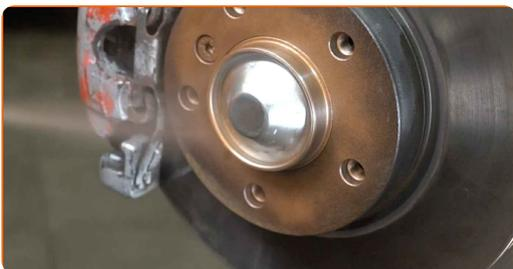
**32** Limpe a superfície do disco de travão. Utilize um produto de limpeza para travões.
