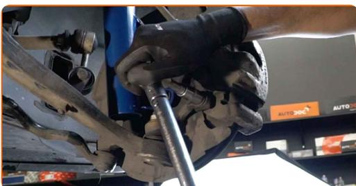
**30** Limpe o local de montagem do aro do pneu. Use uma escova metálica.
