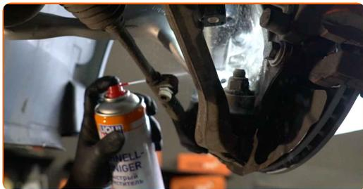
**13** Trate o fixador do sensor de ABS. Use um lubrificante multiusos. Use uma chave de fenda plana.
