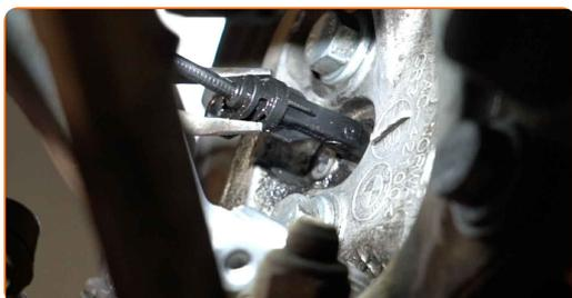
**12** Limpe o assento de montagem do sensor de ABS. Use uma escova metálica. Use o spray de limpeza universal.
