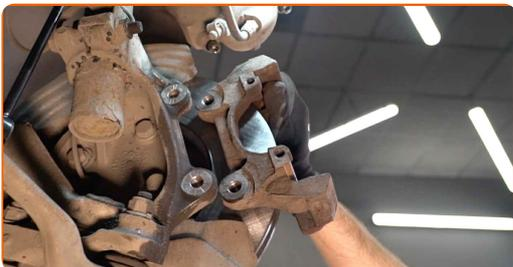
**27** Instale os parafusos de fixação (2 peças).
