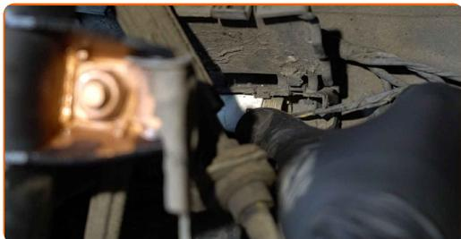
**13** Monte o sensor de desgaste nas pastilhas dos travões.
