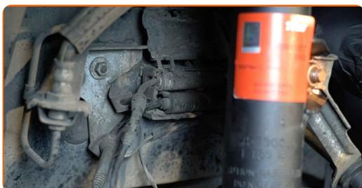
**8** Limpe a tampa do sensor de desgaste da pastilha de travão. Utilize a escova de limpeza de nylon.
