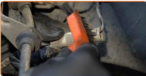
**9** Desconecte o sensor do indicador de desgaste das pastilhas de travão.
