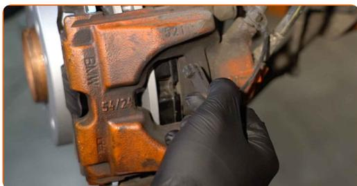
**7** Desconecte o sensor de desgaste das pastilhas do travão.
