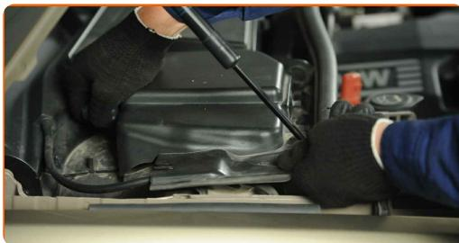
**4** Remova a grelha do para-brisa localizada no lado esquerdo. Use uma chave de fenda plana.
