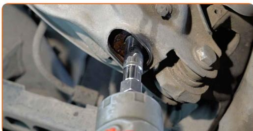
**17** Desaperte a fixação superior do amortecedor.
