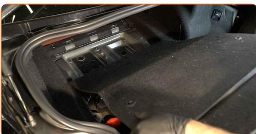
**4** Desaperte o fixador do painel central de plástico de proteção. Use a chave Phillips. Use uma ferramenta de remoção de clipe. Use Torx T40. Use uma chave de catraca.
