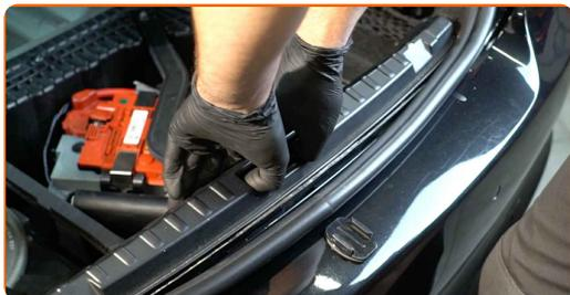
**6** Desaperte o fixador do forro lateral do porta-malas. Use uma ferramenta de remoção de clipe. Use Torx T40. Use uma chave de catraca.
