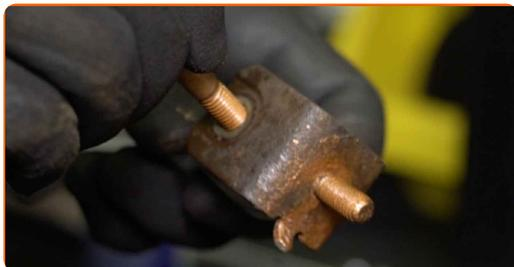
**20** Aparafuse o fixador do suporte da biela do estabilizador. Use uma chave soquete nº 13. Use uma chave de catraca.
