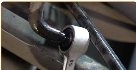
**24** Volte a instalar a barra estabilizadora no seu assento de montagem.
