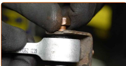
**21** Limpe os assentos de montagem do tirante da barra estabilizadora. Use uma escova metálica. Use spray WD-40.
