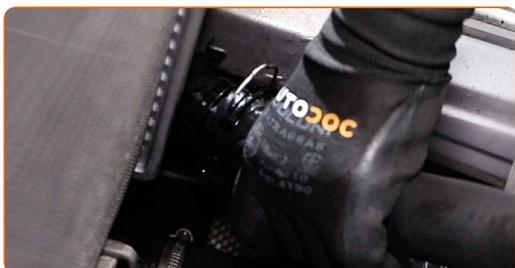
**21** Conecte a braçadeira do tubo inferior do líquido de refrigeração.
