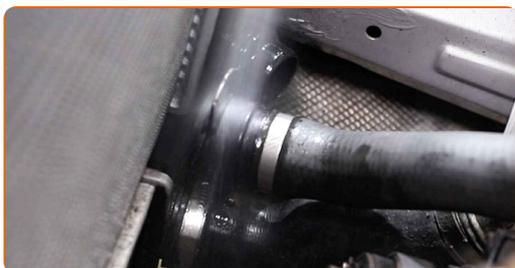
**20** Conecte o tubo inferior do líquido de refrigeração.
