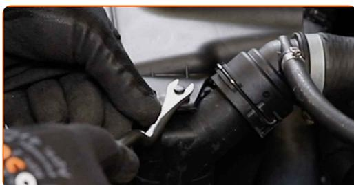
**5** Desaparafuse o fixador do ventilador de refrigeração. Use uma chave combinada nº 32 (2 peças).
