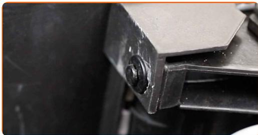
**28** Desaperte o fixador da tampa do motor. Use HEX n.º H5. Use uma chave de catraca.
