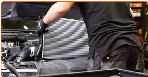
**18** Aparafuse os fixadores do radiador. Use uma chave soquete nº 8. Use uma chave de catraca.
