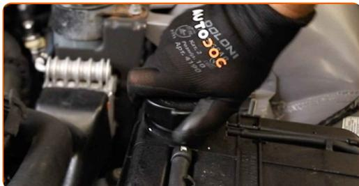
**42** Instale a cobertura do motor e fixe-a.
