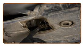
Desaperte o bujão de drenagem. Use uma chave soquete nº 17. Use uma chave de catraca.
