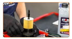
Aparafuse o novo filtro no seu lugar. Use o soquete 86/16 F. Use uma chave de torque. Aperte-o para o torque de 23 Nm.
