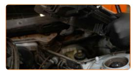
Desaperte a tampa do reservatório de líquido dos travões.
