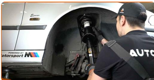
**57** Aparafuse a fixação superior de montagem do suporte do amortecedor. Não o aperte.
