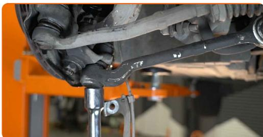
**75** Aparafuse o fixador traseiro que liga o braço da suspensão ao subchassi. Use uma chave combinada nº 16. Use uma chave soquete nº 18. Use uma chave de catraca.
