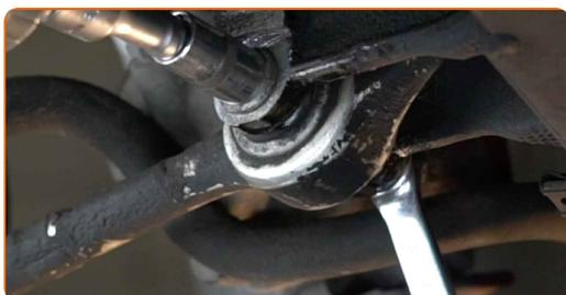
**76** Aperte o braço de fixação dianteiro. Use uma chave combinada nº 18. Use uma chave soquete nº 18. Use uma chave de catraca.
