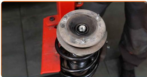
**53** Aperte a porca do suporte do amortecedor da haste do pistão. Use uma chave soquete nº 22. Use HEX n.º H6. Use uma chave de torque. Aperte-o para o torque de 64 Nm.
