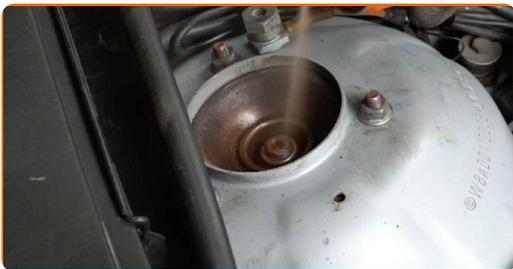
**97** Instale a tampa do apoio da coluna de suspensão.
