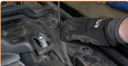
**4** Remova as tampas de proteção do suporte de fixação do amortecedor.
