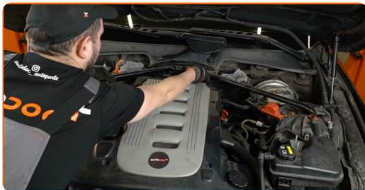
**45** Enrosque os fixadores dos tirantes diagonais. Use Torx T40. Use uma chave de catraca.
