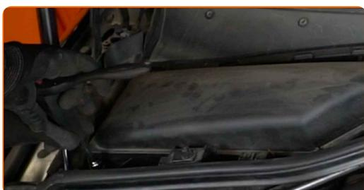
**7** Desenrosque os fixadores da parte inferior da carcaça do filtro de habitáculo. Use Torx T25. Use uma chave de catraca.
