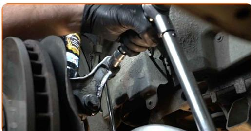
**14** Aperte o fixador que conecta a bieleta da barra estabilizadora à barra estabilizadora. Use uma chave soquete nº 16. Use uma chave de torque. Aperte-o para o torque de 65 Nm.
