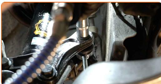
**13** Desaparafuse o fixador que conecta bieleta da barra estabilizadora à barra estabilizadora. Use uma chave soquete nº 16. Use uma chave de torque. Aperte-o para o torque de 65 Nm.
