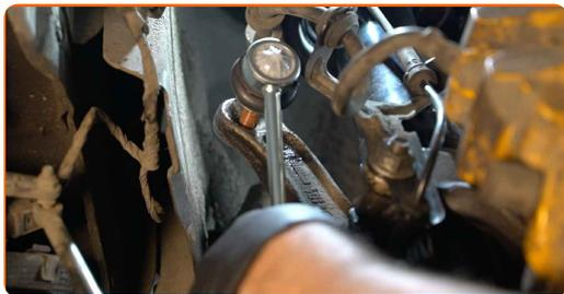
**12** Aperte o fixador da bieleta da barra estabilizadora. Use uma chave soquete nº 16. Use uma chave de catraca.
