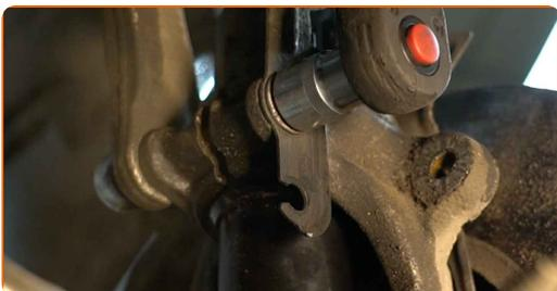
**70** Limpe os locais de montagem e a rosca do braço da suspensão. Use uma escova metálica. Use spray WD-40.
