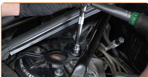
**109** Trate os fixadores do apoio da coluna de suspensão. Use massa de cobre.
