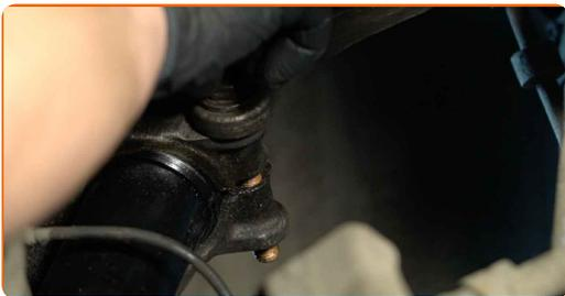
**68** Aparafuse o fixador do suporte da biela do estabilizador. Use uma chave soquete nº 16. Use uma chave de catraca.
