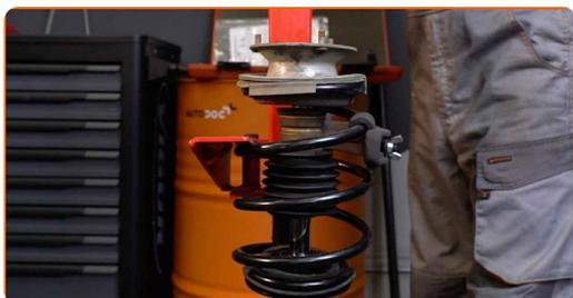
**61** Retire a coluna de suspensão montada.
