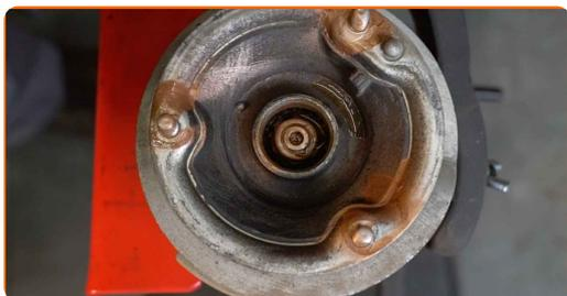
**59** Instale a tampa do apoio da coluna de suspensão.
