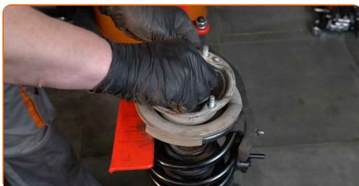
**57** Aperte a porca do suporte do amortecedor da haste do pistão. Use uma chave soquete nº 22. Use HEX n.º H6. Use uma chave de torque. Aperte-o para o torque de 64 Nm.
