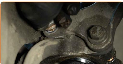
**69** Aparafuse o fixador que conecta o amortecedor à manga de eixo. Use uma chave soquete nº 18. Use uma chave de catraca.
