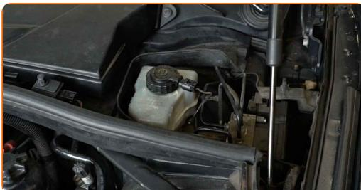
**4** Desaperte a tampa do reservatório de líquido dos travões.
