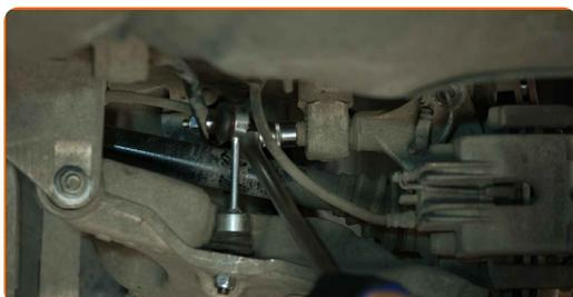
**16** Remova o parafuso de fixação. Use uma chave combinada nº 18. Use uma chave de fenda plana.
