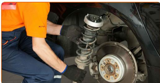
**38** Aparafuse a fixação superior de montagem do suporte do amortecedor.
