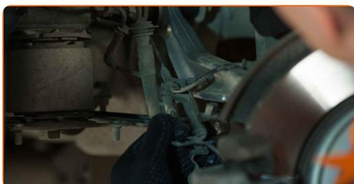
**8** Limpe todas as juntas do braço. Use uma escova metálica. Use spray WD-40.
