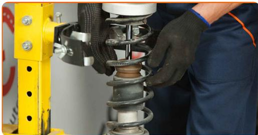
**36** Retire a coluna de suspensão montada.
